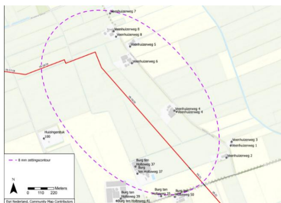
Figuur 7.1 | Panden met risico op zettingsschade
