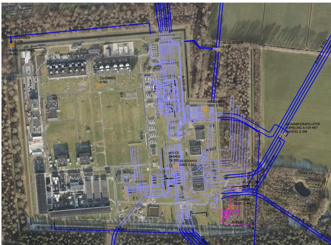
Afbeelding 1: Bestaande situatie CS Ommen met in roze stippellijn de leiding en het schema dat geen onderdeel meer zal zijn van de beheerde locatie
