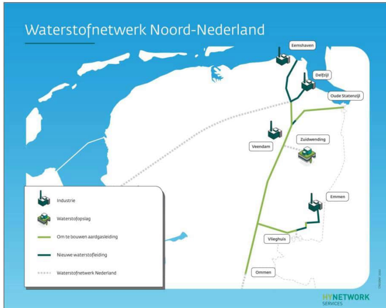
Afbeelding 1: Schematische weergave van het Waterstofnetwerk Noord Nederland (bron: Gasunie).
