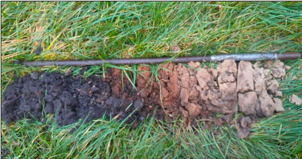
Afb. 3.5 Bodemopbouw van boring 89 met links de donkere A-horizont, overgaand in een roodbruine Bs-horizont en rechts de lichtgele C-horizont. Dit betreft een deels intacte podzolbodem waarbij de E-horizont waarschijnlijk is opgenomen in de bouwvoor.
