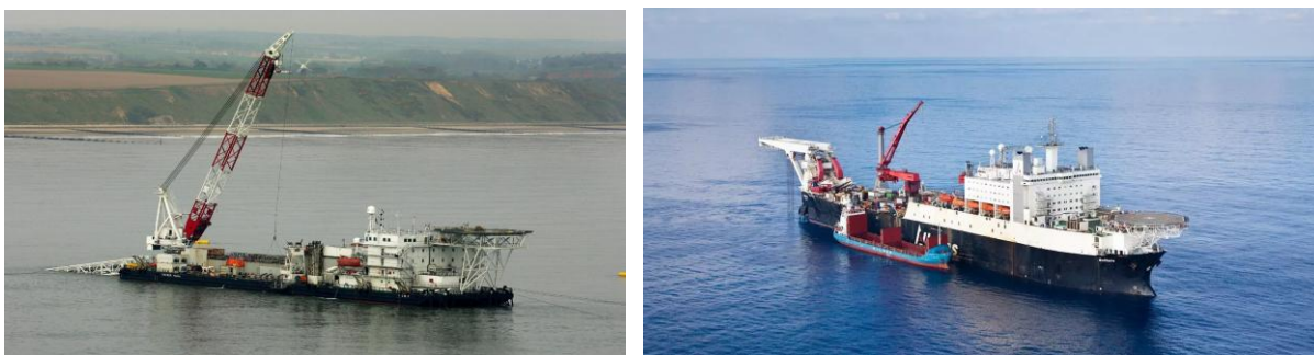
Figuur 5-1: Pijpleggerschepen – op ankers (l) en Dynamic Positioning (r)
