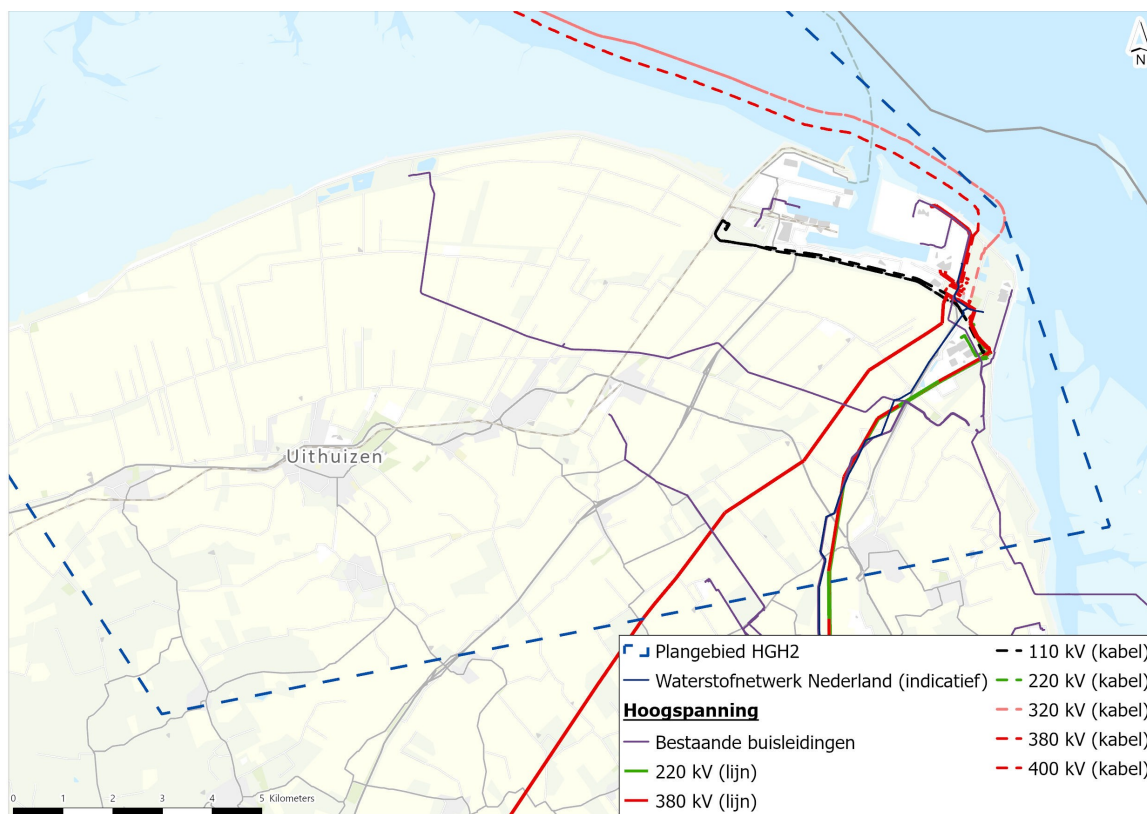
Afbeelding 8.4 Huidige situatie kabels en leidingen
