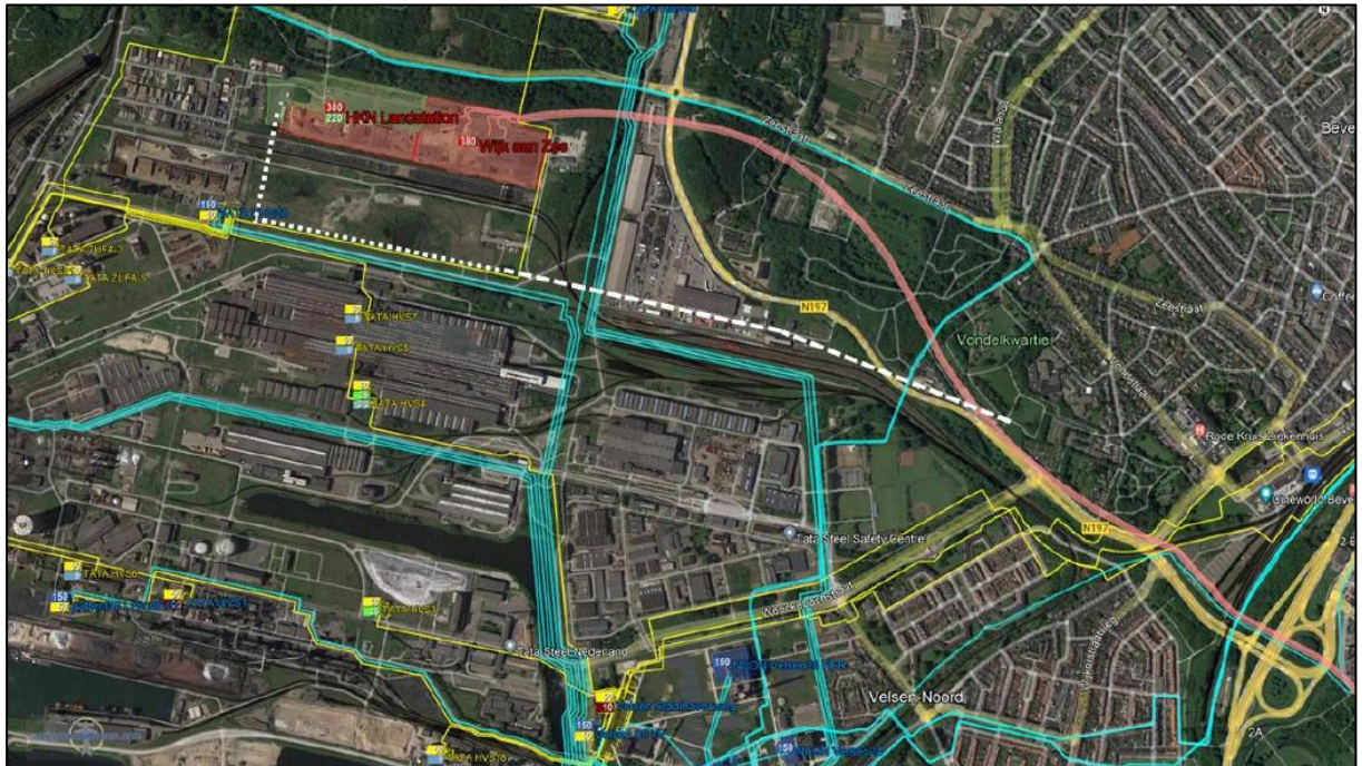
Figuur 16-3 Een deel van de kabels en leidingen in de ondergrond in deelgebied I (bron: Arcadis, 2023)
