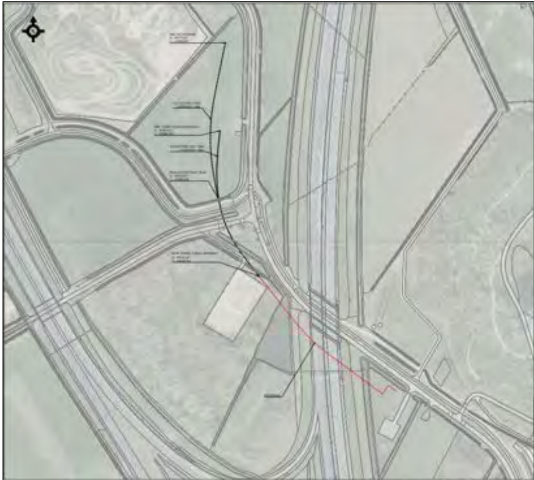
Figuur 1.6. De exacte locatie van de uitlegstrook, de HDD boring en het intredepunt. Bron: Gasunie, 2024.
