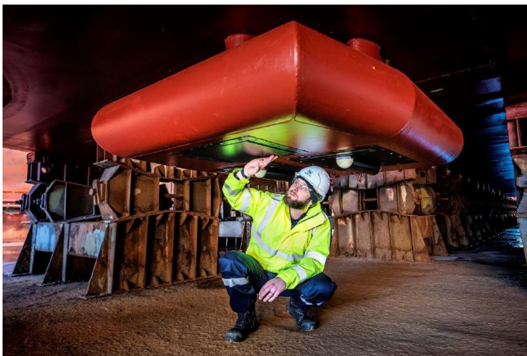
Figuur 3-4. Glomar Supporter romp met gondel met MBES en SBP.
