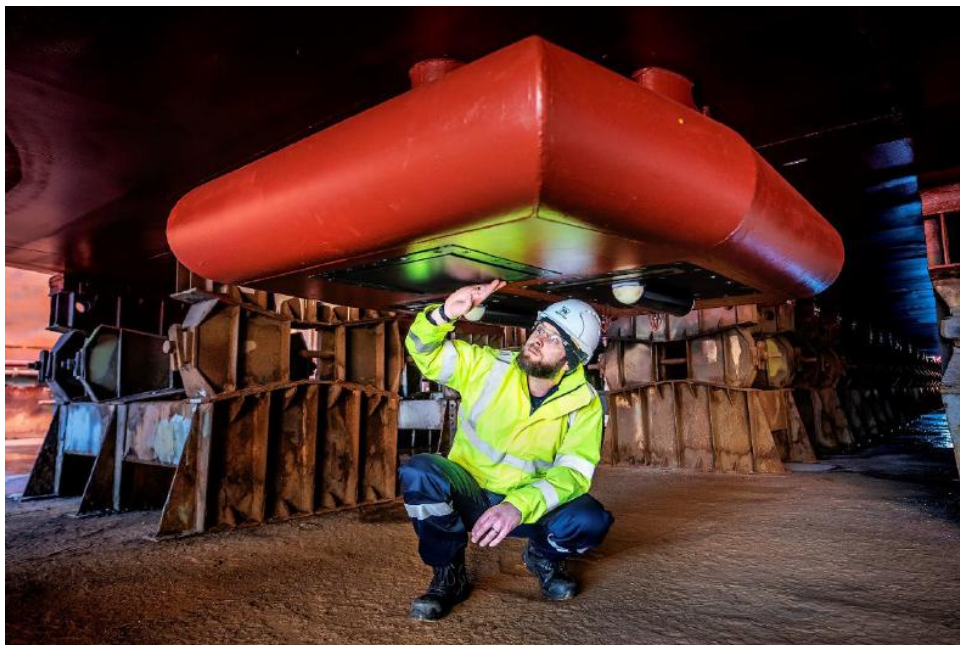
Figuur 3-2. Glomar Supporter romp met gondel met MBES en SBP.
