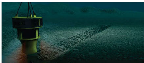
Figuur 5: Voorbeeld van een Mass Flow Excavator (MFE)
