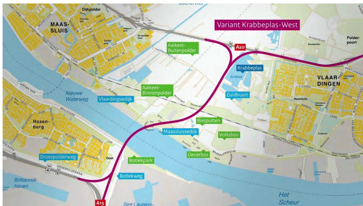
Figuur 6.2 Geplande aansluiting Blankenburgtunnel op de A15
