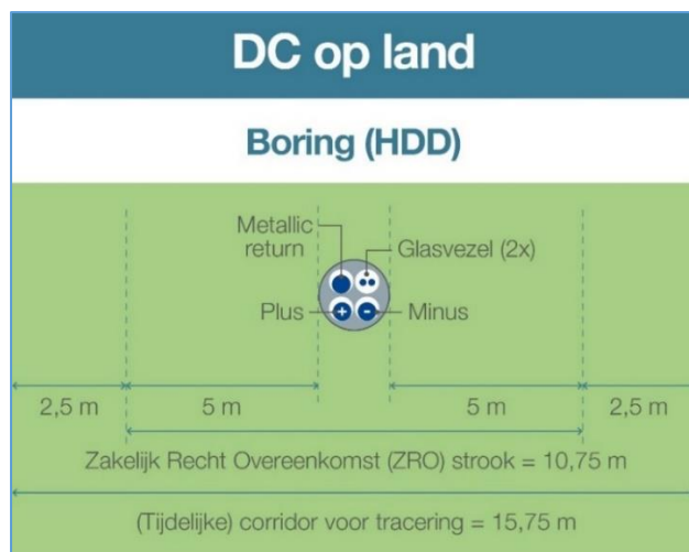
Figuur 2-1 Configuratie kabelsysteem DC-verbinding
