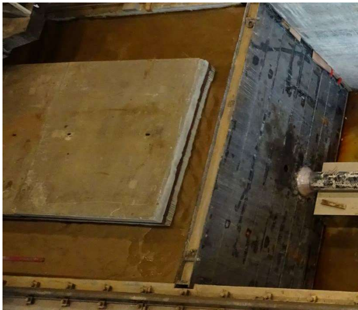
Figuur 3.2 Proefopstelling voor het uittrekken van de leiding.
