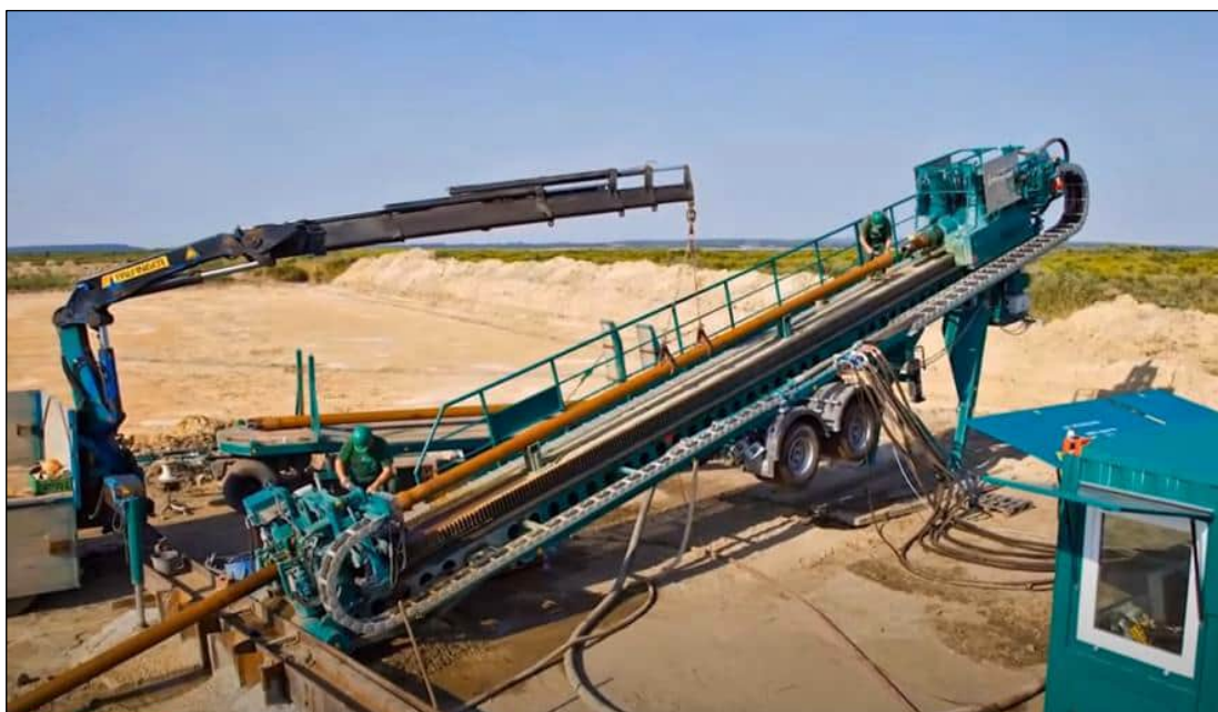
Figuur 8: Boorstelling (rig) voor de uitvoering van een horizontaal gestuurde boring. Ontleend aan: www.herrenknecht.com
