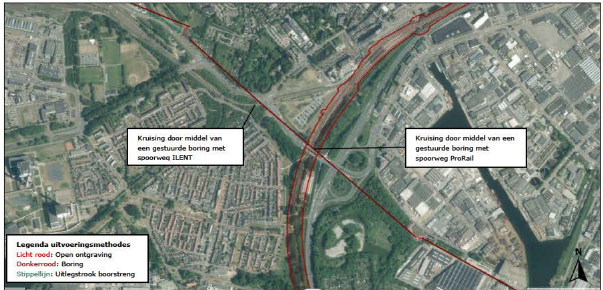
Figuur 3: HDD 2 Geocode 076, km 11,1 – 11,2. Bijbehorende tekeningen: A-825-01-KR-008 en 009 en detailkruisingstekening A-825-01-XW-006-1
