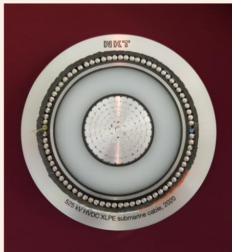
De drie stroomkabels van één kabelsysteem (links) en een dwarsdoornede van een stroomkabel (rechts)
