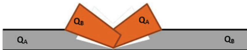
Figuur 9: Aantal jets en bijdragen vanuit stroomopwaartse en stroomafwaartse leidingdelen voor breuk van een bovengrondse leiding
