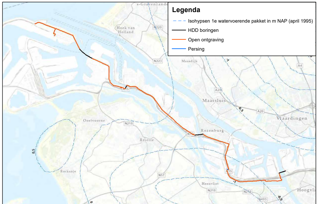
Figuur 2.6: Stijghoogten 1 e watervoerende pakket in m NAP conform TNO in april 1995
