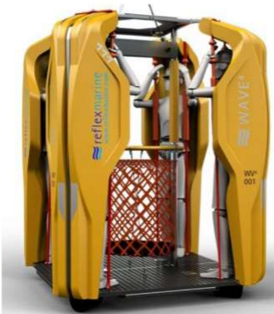
Figuur 9 (L) Personen vervoer met basket (WAVE 4), (R) het T-card systeem
