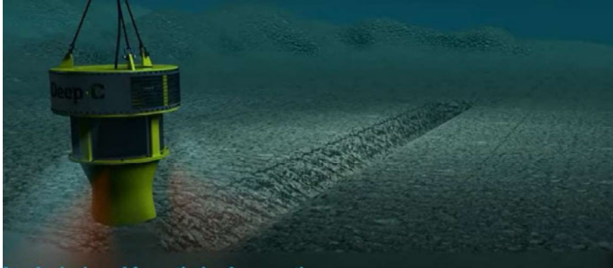
Figuur: Voorbeeld van een Mass Flow Excavator (MFE)
