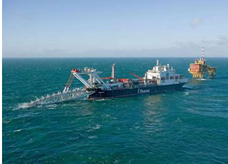
Figuur: Verwijderen van pijpleidingen met behulp van reverse S-Lay
