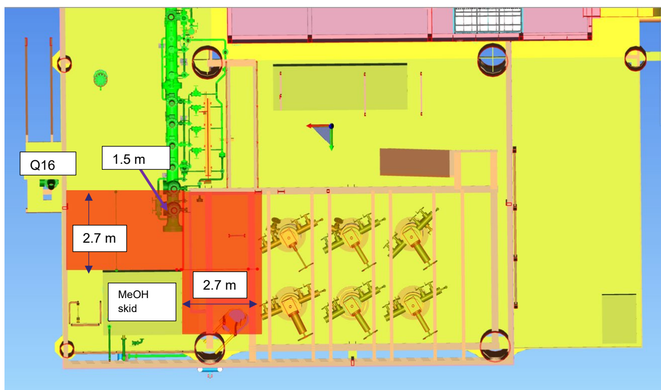
Figuur 3 Effect afstand 10 \text{ kW/m}^2 bij plasbrand methanol – 6 \text{ m}^2
