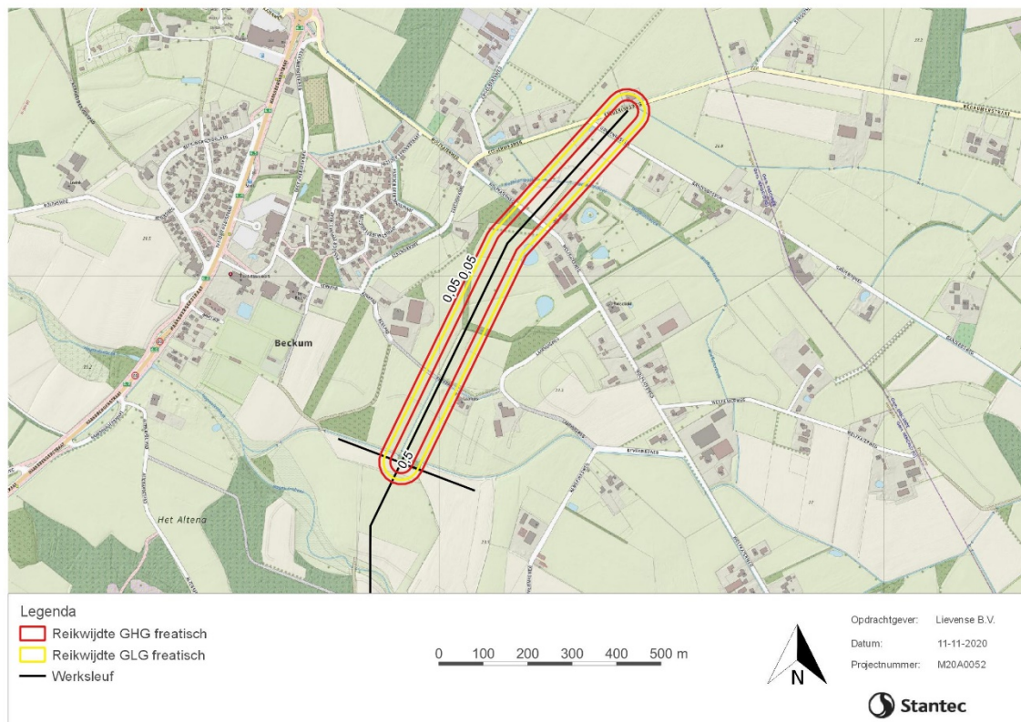
Figuur 5: Theoretisch invloedsgebied (verlagingscontour 0,05 meter en 0,5 meter) bij bemaling onder GHG (rode lijnen) en GLG (gele lijnen)
