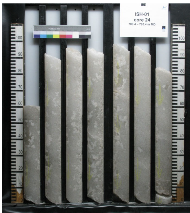
Figuur 4-5: Delen van boorkern, boring ISH-01 (schaal in cm).
