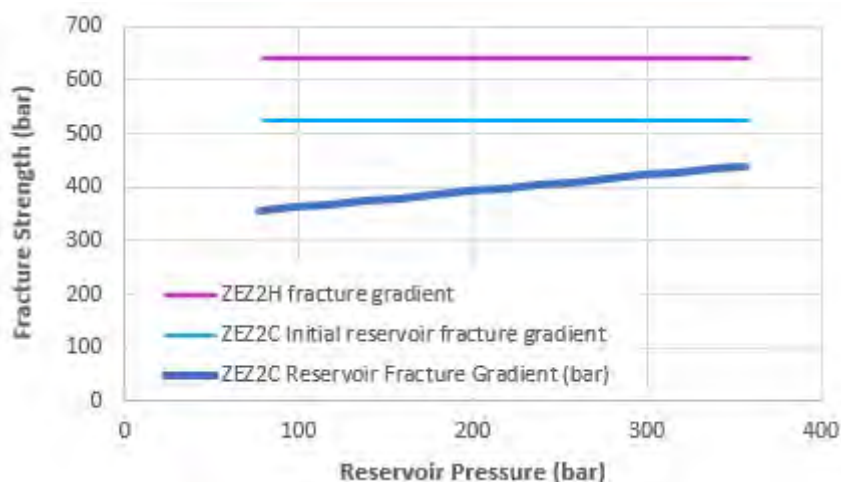
Figuur 6-12: Reservoir fracture gradient als functie van de reservoirdruk (donkerblauw) vergeleken met de initiële fracture gradient (lichtblauw) en de fracture gradient van de caprock (ZEZ2C in magenta). De reservoir fracture gradient neemt toe als functie van de druk als gevolg van de deels reversibele spanning.
