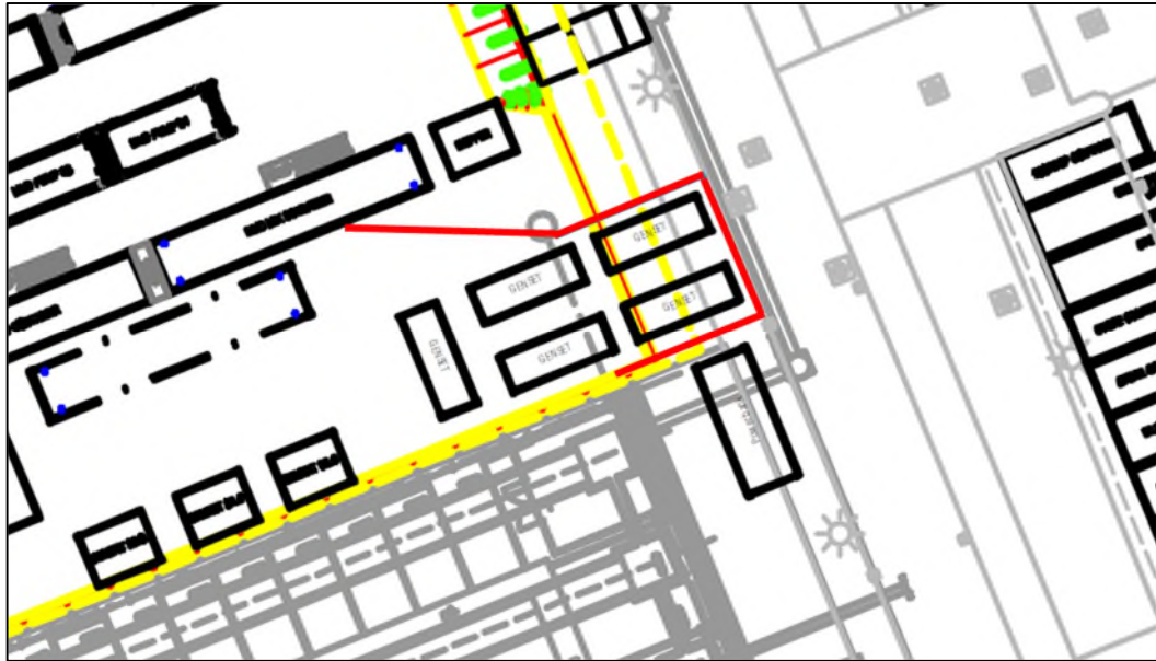
Afbeelding 2 Schematische weergave absorberend geluidscherm (rood) van 6,2 m hoogte.
