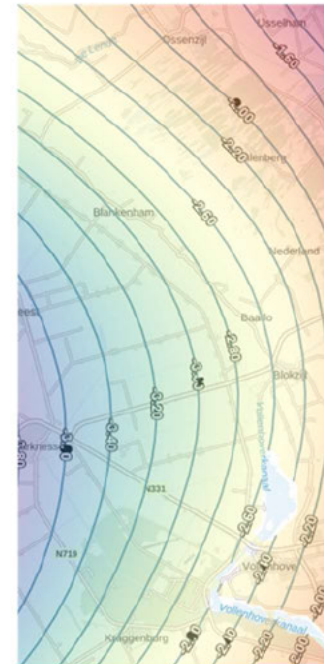
Figuur 7.14 | stijghoogtes 1 e (links), 2 e (midden) en 3 e (rechts) watervoerend pakket (WVP) (bron: Landelijk Hydrologisch Model en peilbuizen)
