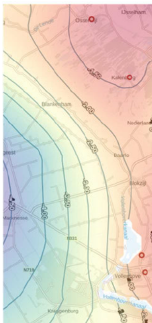
Figuur 7.14 | stijghoogtes 1 e (links), 2 e (midden) en 3 e (rechts) watervoerend pakket (WVP) (bron: Landelijk Hydrologisch Model en peilbuizen)
