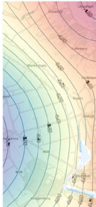
Figuur 7.14 | stijghoogtes 1 e (links), 2 e (midden) en 3 e (rechts) watervoerend pakket (WVP) (bron: Landelijk Hydrologisch Model en peilbuizen)
