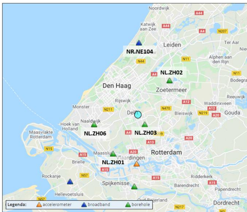
Figuur 4-6 Overzicht van seismometers van het KNMI. Het netwerk bestaat uit geofoons in de boorgaten (tot 200m diepte), versnellingsmeters en 'broadband' seismometers (Bron: knmi.nl). Geothermie Delft aangeduid met blauwe cirkel.
