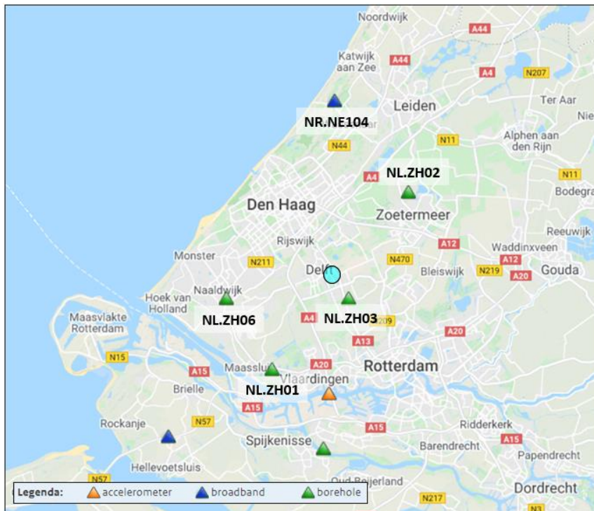
Figuur 5.3 Overzicht van seismometers van het KNMI. Het netwerk bestaat uit geophones in de boorgaten (tot 300m diepte), versnellingsmeters en 'broadband' seismometers (Bron: https://www.knmi.nl/nederland-nu/seismologie/stations ). Geothermie Delft aangeduid met blauwe cirkel.
