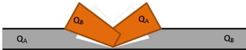
Figuur 4-1: Aantal jets en bijdragen vanuit stroomopwaartse en stroomafwaartse leidingdelen voor breuk van een bovengrondse leiding [5].
