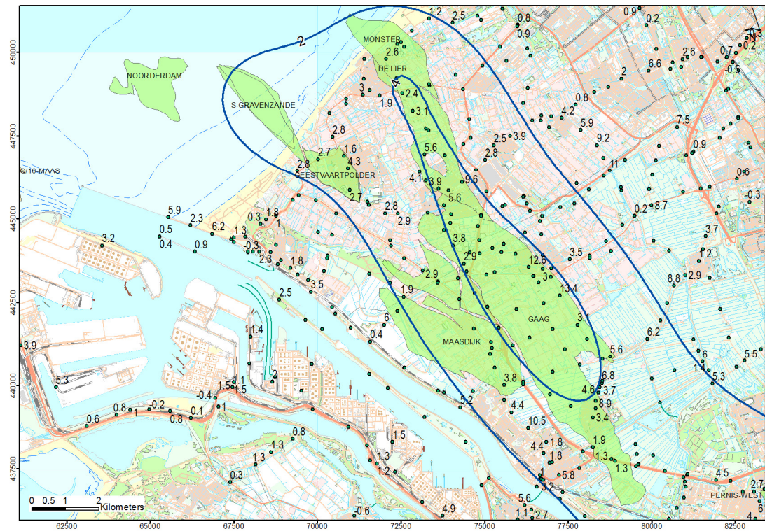
Figuur 7-3: In 2016 gemeten bodemdaling sinds de nulmeting in 1989 weergegeven op de peilmerken (groene punten). De contouren geven de gemodelleerde bodemdaling in cm.
