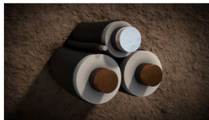
DC-kabelsysteem op zee
