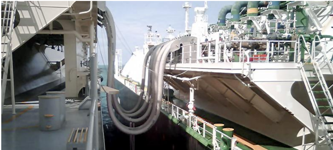
Figuur 2-3 Bovenstaande afbeelding laat zien hoe LNG van de LNG-carrier (rechts op de afbeelding) naar de FSRU (links op de foto) wordt getransporteerd met flexibele slangen
