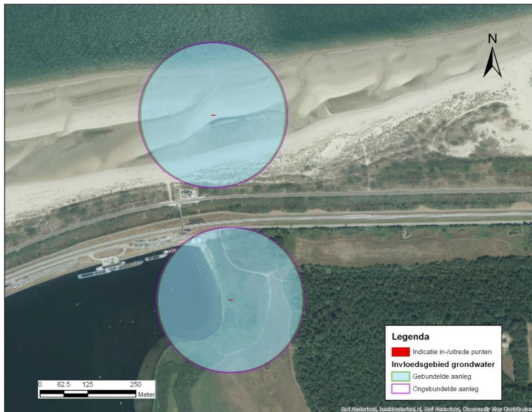
Figuur 2-1 Invloedsgebied grondwater als gevolg van bemaling - Veerse Gatdam
