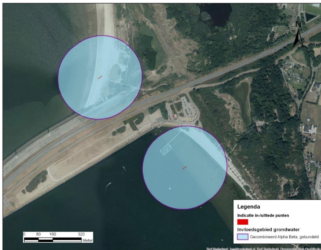
Figuur 2-3 Invloedsgebied grondwater als gevolg van bemaling bij een gecombineerde aanleg Alpha en Beta – Haringvlietdam
