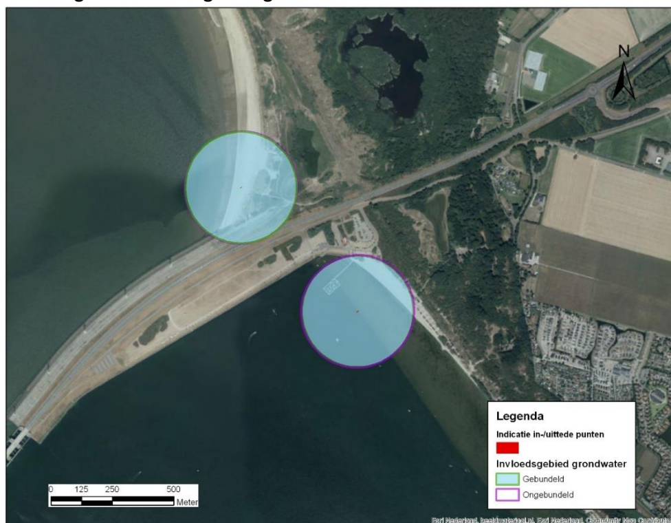
Figuur 2-2 Invloedsgebied grondwater als gevolg van bemaling – Haringvlietdam
