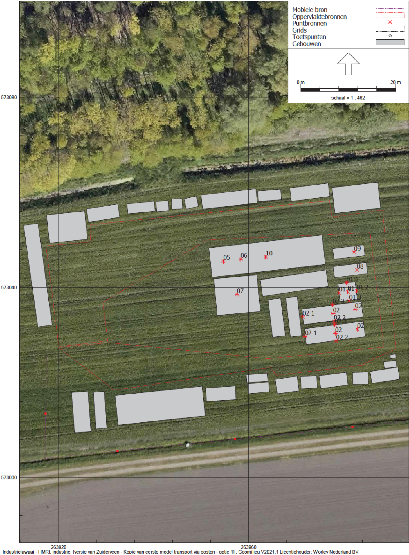
Bijlage 1.8, Overzicht geluidbronnen en gebouwen backup proefboring
