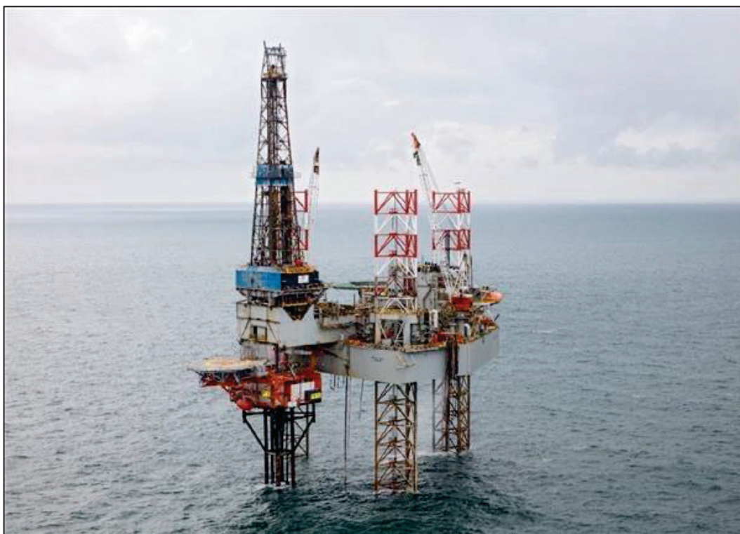
Figuur 7 Impressie van een zelfheffend boorplatform (rechts) tijdens het uitvoeren van een boring
