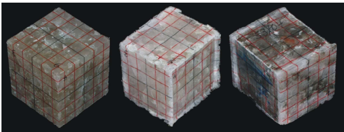
Abb. 2.2: Würfelproben vor (links) und nach dem echt-triaxialen Versuch: Kompression (Mitte) und Extension (rechts).
