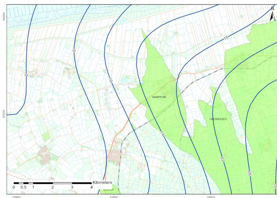
Figuur 7-6: Voorspelling van de totale bodemdaling door gaswinning in 2030. De contourlijnen geven de bodemdaling in cm aan.
