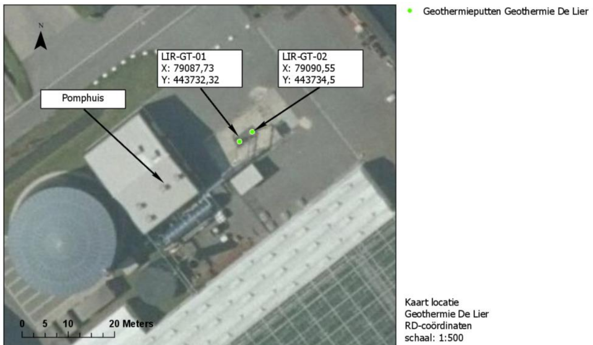
Figuur 2: Locatie geothermisch systeem Geothermie De Lier, met de coördinaten van de wellheads
